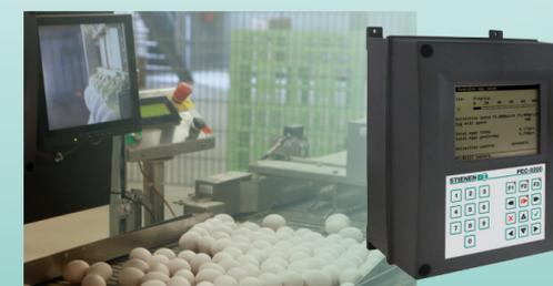
将鸡蛋以应有的谨慎和最佳速度运给鸡蛋包装机是重要的步骤。鸡蛋计数功能仔细记录每层和每排鸡蛋的产蛋数量，并为您提供鸡蛋生产的全面视图。反转检测（可选）确保鸡蛋输送机的任何反转运动不会扭曲鸡蛋计数。您可以控制和监视整个过程。如果您看到这个过程运行顺利，没有任何中断，你就知道您的家禽表现不错。
