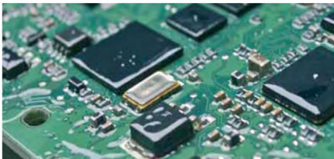
El recubrimiento de la parte electrónica proporciona una mayor seguridad de funcionamiento y una mayor vida útil.
