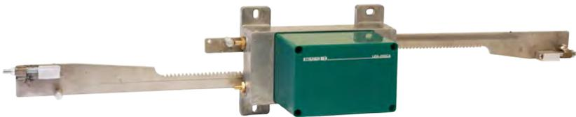
**EGM liermotor:** un robusto motor de 24 V sin escobillas y con una fuerza de tracción de 100 o 250 kg. La serie EGM lleva enrollable de serie y está disponible con control 0-10V o potenciómetro de retroalimentación.
