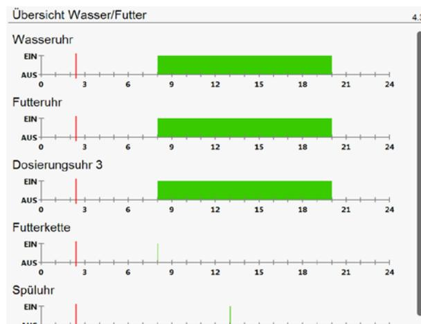
Bei einer Dosieruhr ist der Schaltuhrausgang mit einem Zählereingang verbunden. Sie können dann die Wasser- und/oder Futteraufnahme begrenzen. Wenn die Futteraufnahme zu niedrig ist, können Sie den Regelcomputer veranlassen, einen *Dosierungsalarm* auszulösen und die Wasser-/Futterdosierung zu stoppen. Wenn Ihr Installateur die Einstellung *Dosierung* auf *nein* gesetzt hat, verhält sich die Dosieruhr wie eine traditionelle Zeitschaltuhr.
