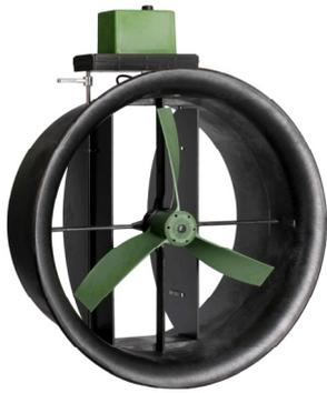
AQC створка может служить как регулятор измерительных и регулирующих агрегатов в централизованной системе вытяжки воздуха и как измерительный и дроссельный агрегат под вентиляционными шахтами. Обладая прекрасными аэродинамическими характеристиками измерительного вентилятора и створки двойного контроля створка агрегата AQC -надёжная система контроля за вентиляцией. Производительность вентиляции может регулироваться створкой AQC от 0,4м/сек до максимального значения.
