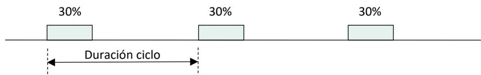
**Duración ciclo** La distribución del alimento en el tubo de transporte y, por consiguiente, la cantidad de alimento para los animales se determina en función del porcentaje de llenado y de la duración del ciclo.
