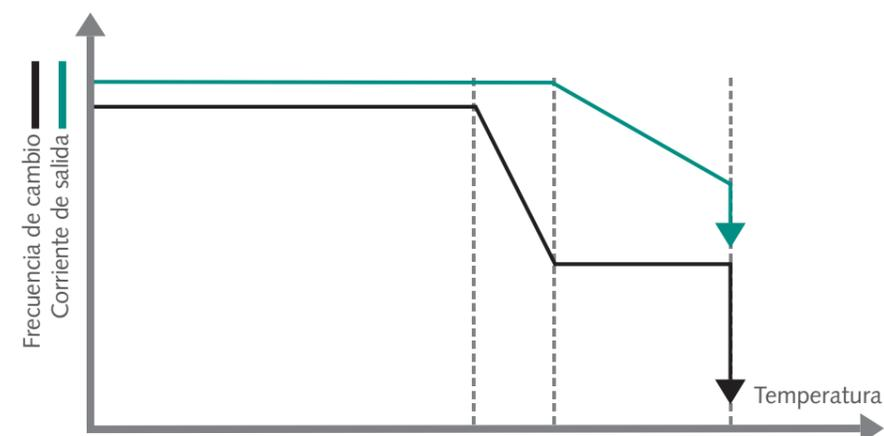
Un convertidor VLT® se ocupa de los periodos breves de exceso de temperatura modificando la frecuencia de conmutación y reduciendo la corriente de salida. Así, el sistema motor (la ventilación) se mantiene en marcha.
