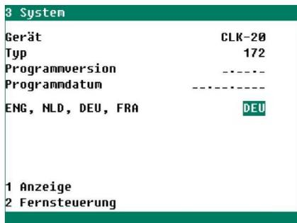
Dieser Bildschirm zeigt den Namen dieses *Geräts*, den *Gerätetyp* (CLK-20 = 172), die *Programmversion* und das *Programmdatum* an. Deutschsprachige Benutzer stellen die Sprache auf *DEU* (Deutsch) ein. Sie können die Sprache schnell ändern, indem Sie die Funktionstaste F1 gedrückt halten und gleichzeitig die linke oder rechte Cursortaste drücken.
