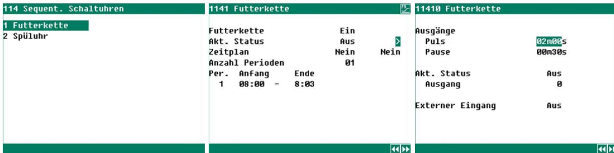
Bei einer sequenziellen Uhr werden die der Schaltuhr zugeordneten Ausgänge nacheinander aktiviert. Ein Ausgang wird erst dann aktiviert, wenn der vorherige Ausgang nicht mehr aktiv ist. Die verschiedenen Aktionen, die nacheinander ausgeführt werden, werden auch als Phasen oder Schritte bezeichnet.
