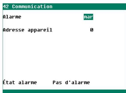
Une alarme de communication peut survenir sur une station principale si la station principale n'a pas reçu de données d'un appareil qui fait partie de la même bouche de communication RS-485.
