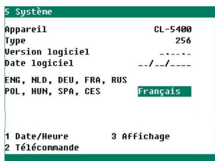
Sur cet écran figurent, en plus du nom du dispositif, notamment le type de dispositif (256 = CL-5400), la version de programma (*version logiciel*) et la date de programma (*Date logiciel*) sont également répertoriés.
