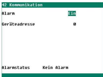
Ein Kommunikationsalarm tritt bei einem Mastergerät auf, wenn dieses Gerät keine Daten von einem Gerät in derselben RS-485-Datenkommunikationsschleife empfangen hat.
