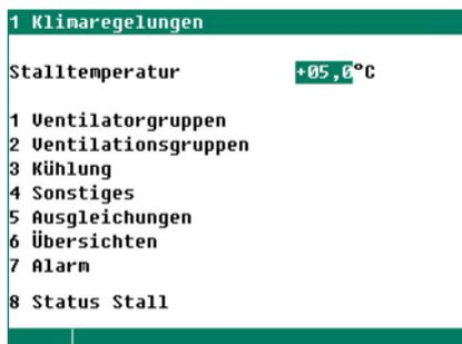
Auf Basis der Stalltemperatur werden die Lüftungsgruppen, Kühlung und Heizung geregelt.
