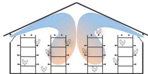
Bei Volieren- oder Käfighaltung kann die AeroWing SC hoch angebracht werden, damit zwischen dem Dach und den Unterküften noch gelüftet wird.
