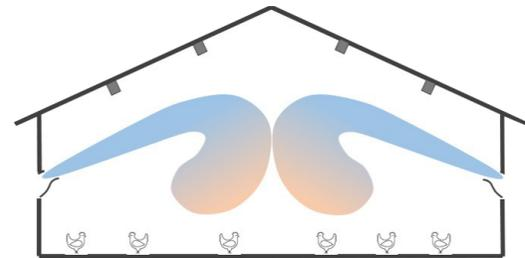
Bei einer Bodenhaltung kann die AeroWing niedrig angebracht werden, da die Wurfweite von der Dachschräge unabhängig ist. Außerdem wirken sich Hindernisse am Dach wie Sparren, Leuchtkörper oder angebrachte Futterreihen und Tränken nicht auf die Luftverteilung aus.
