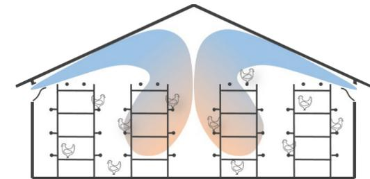
Bei Volieren- oder Käfighaltung kann die AeroWing hoch angebracht werden, damit zwischen dem Dach und den Unterküften noch gelüftet wird.
