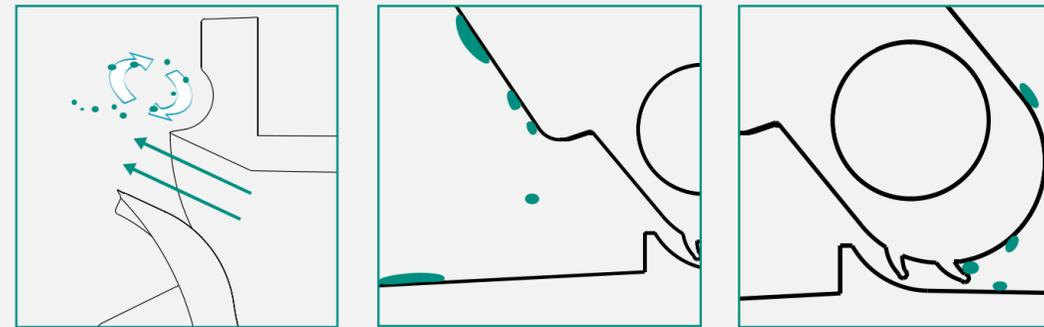
Die Lufterlassklappe nutzt den Venturi-Effekt, damit die Stallluft zusammen mit der Eingangsluft angesaugt wird. Die runde Aussparung verstärkt die Turbulenz der Stallluft, sodass sich Kondensat nicht mehr auf der Klappe niederschlagen kann.
